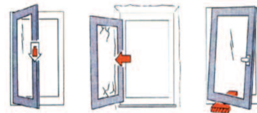
Okenní křídlo nesmí být vystaveno přídatnému zatížení
